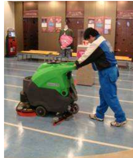
Mikrofaserpad (600 g/m - 0,28 lt/min)
