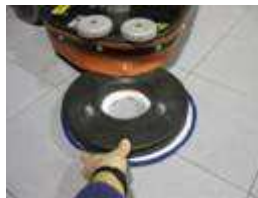
Werkzeugloses Auswechseln von Pad und/oder Bürste
